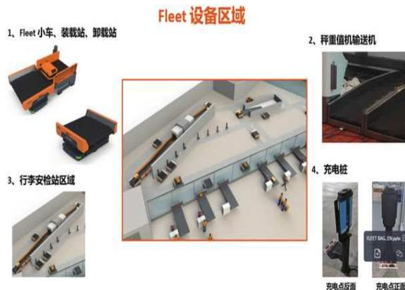
在国内新建机场的建设中,已有采用 FLEET Bag 系统完成部分高端旅客行李交运处理的应用实例。在设计建设中由于采用了无人驾驶的运输方式,加之自动化程度高,机场可在提升流程可靠性的同时降低成本。减少了对人力的依赖后,运营稳定性得到提升,这让工作人员可以将精力放在机场的其他优先事项上。得益于其配置和自动化程度,FLEET 可降低对人员的培训要求,而且新的流程可以自动纳入到系
