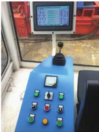
图3 驾驶室内监控及操作
