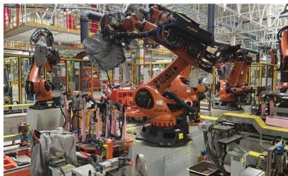
焊接机器人是焊机自动化技术研发重点，企业可以加快研发机器人控制系统、焊枪、机器人末端执行器、
