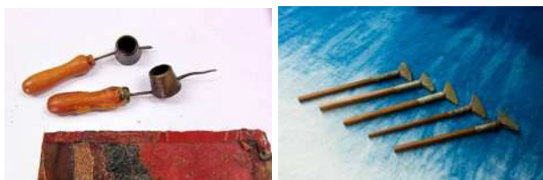
图4.1 印尼的蜡壶和贵州苗族的蜡刀
