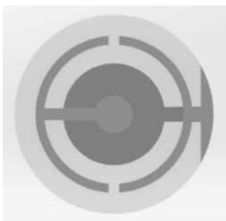
图 2.1 5MHz 石英晶体微天平电化学晶片
