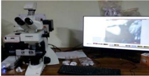
图2. 配有与计算机相连的油浸透镜的岩相学装置。
