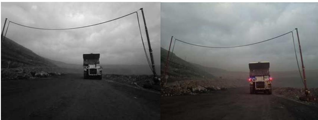
图(4) 过电缆桥时厢斗举起时的对比图(安装前和安装后)在安全地点拍摄且有专人指挥
