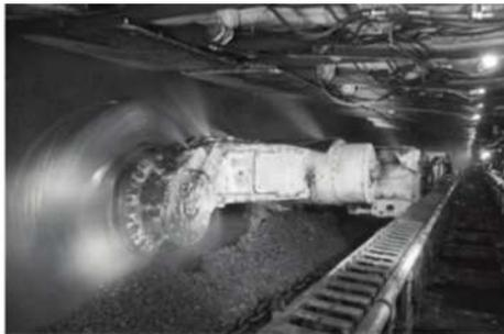
图4 薄煤层无人开采工作面
