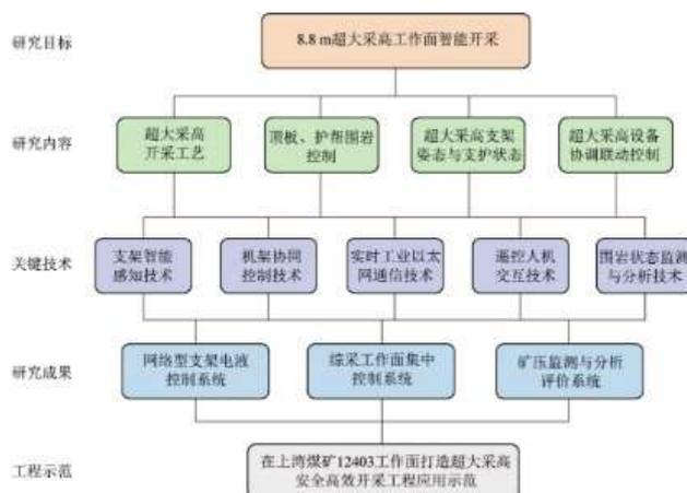
图2 超大采高工作面智能化技术路线
