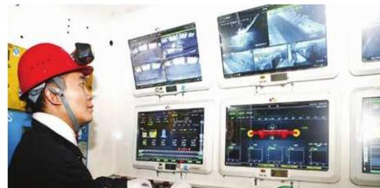
通过自动化控制系统, 掘进机可以实现智能化控制、自适应调整、作业监测等功能。例如, 掘进机在工作时会遇到煤层硬度不同的情况, 传统的操作方式需要人工进行调整, 而通过自动化控制系统, 掘进机可以根据煤层硬度自动调整刀盘的转速和刀盘的倾斜角度, 以保持设备在最佳状态下工作。
