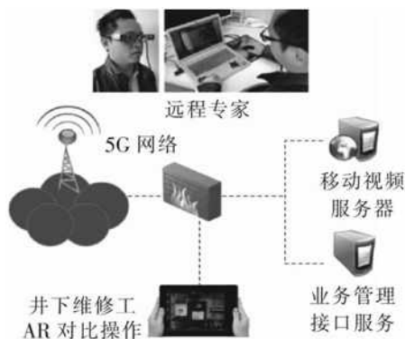
图 1 基于 5G 技术的远程运营维护场景结构
