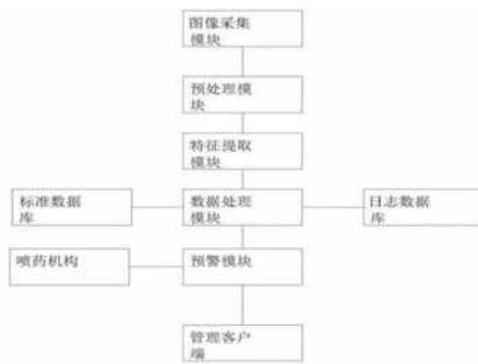
图2 基于图像识别的病虫草害识别与报警系统流程
