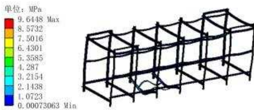
图10 优化后机架等效应力云图
