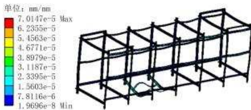
图9 优化后机架等效应变云图
