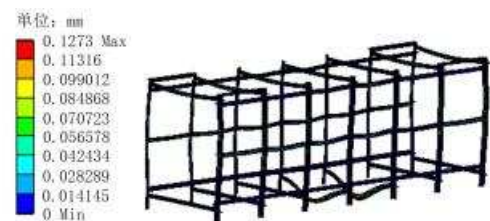
图5 机架总位移云图
