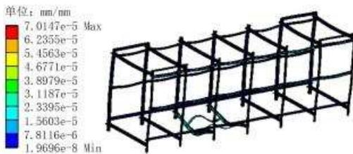
图9 优化后机架等效应变云图
