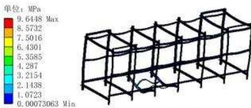
图10 优化后机架等效应力云图
