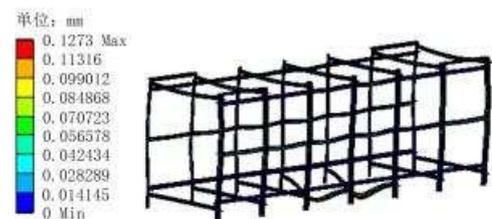
图5 机架总位移云图
