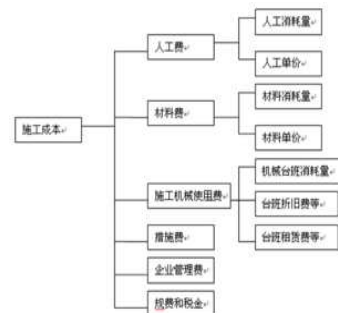
图1 水利工程施工成本管理
