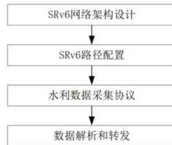
图2 基于SRv6的水利数据采集实现流程
