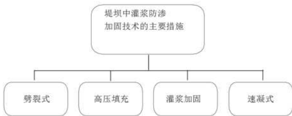
图 1 堤坝灌浆防渗加固技术体系
