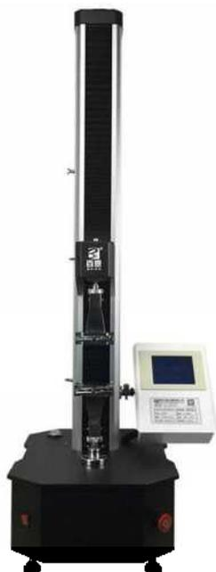
图2 断裂伸长率检测设备
