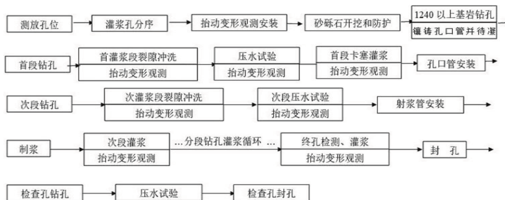
图3 水利工程灌浆施工工艺
