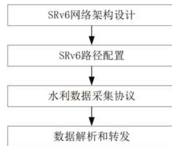
图2 基于SRv6的水利数据采集实现流程
