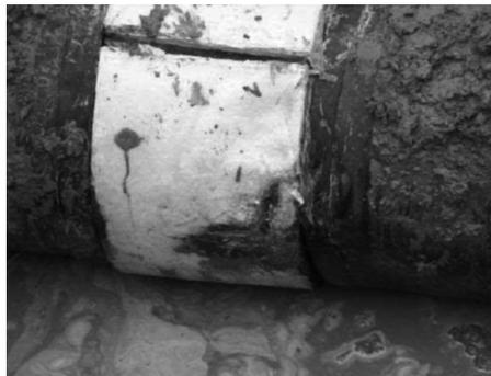
图1 油田地面工程管道的外腐蚀现象
