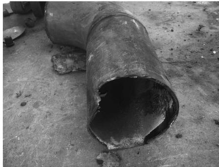
图2 油田地面工程管道的内腐蚀现象
