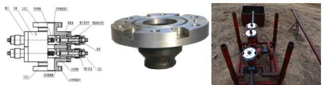
图1 双闸板防喷器 图2 自封封井器 图3 井控管汇
