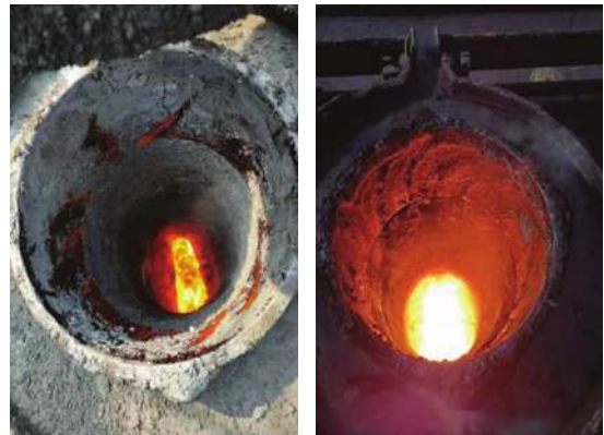
图9 导烟孔根部清理石墨前后对比图
