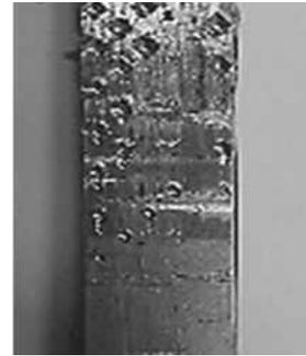
图2 过大的夹持力造成加强片扭曲变形
