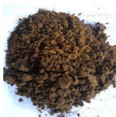
图 3. 干燥后 600μm 大小的美洲鳄梨种子。
