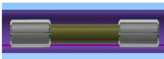
图 5 油管、特殊接箍、电缆装配示意图
