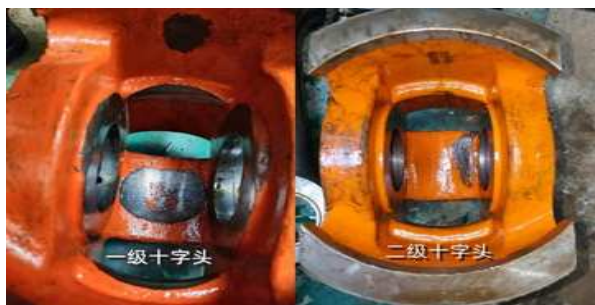
图1: 一级十字头与二级十字头拆解的情况对比
