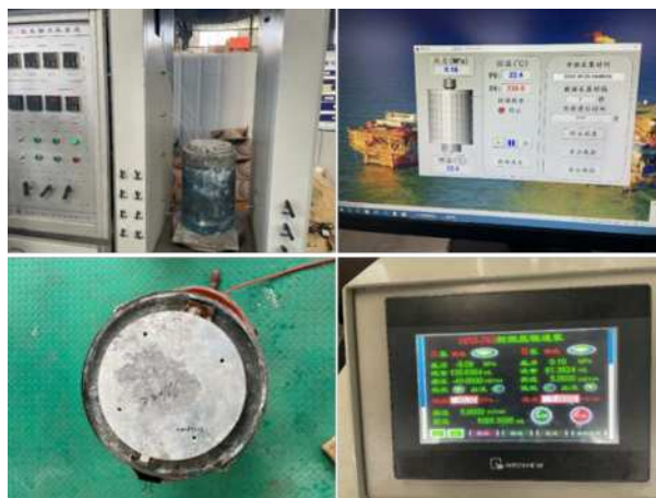
图 1 非金属套管井筒室内评价装置实物图与测试界面 水泥浆配方:
