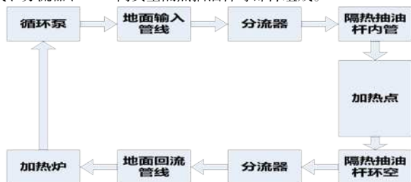
图12 双空心杆水循环工艺流程图
