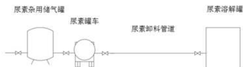
改造后尿素卸料系统
