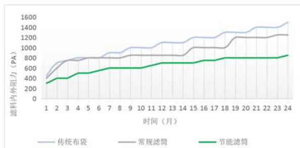
图7 过滤元件运行时内外压差
