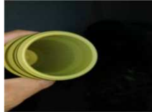
图9 重铬酸钾封闭膜层状态 图10 醋酸盐封闭膜层状态
