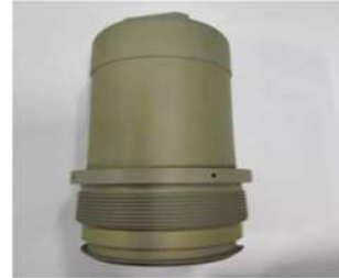
图11 经盐雾试验后重铬酸钾封闭膜层状态
