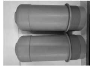
图9 重铬酸钾封闭膜层状态 图10 醋酸盐封闭膜层状态
