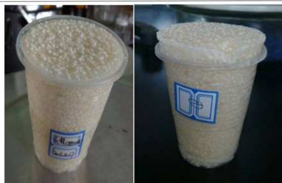
图 3-2 乳化炸药发泡过程前后对比图
