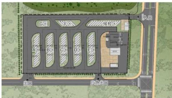
图 2.1 危险品运输车辆停车场项目分区平面图
