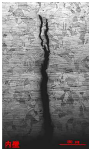
图 2 裂纹尖端轴向截面裂纹形貌及金相组织
