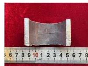
b. 管段内壁局部形貌及取样位置
