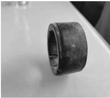
图3 技术改进前的原配轴套
