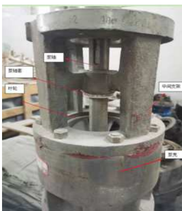
图2 本厂所用到的深井泵的实拍图
