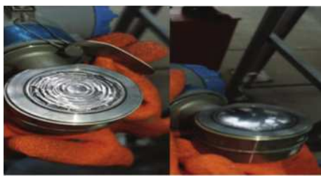
图一 故障变送器解体后膜片照片
