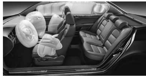
图1 汽车座椅安全气囊示意图
