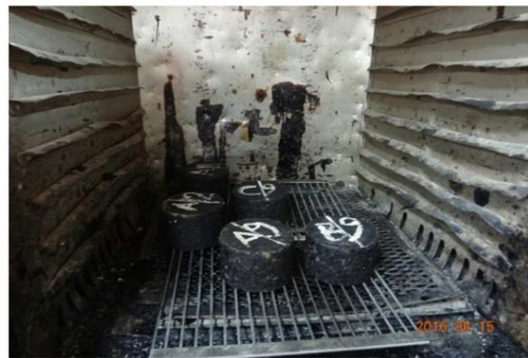
图 3. 加热裂缝愈合。
