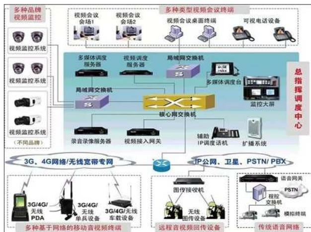
图 1 总指挥调度中心流程图
