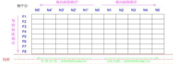
图 1 钢平台拆除顺序示意图
