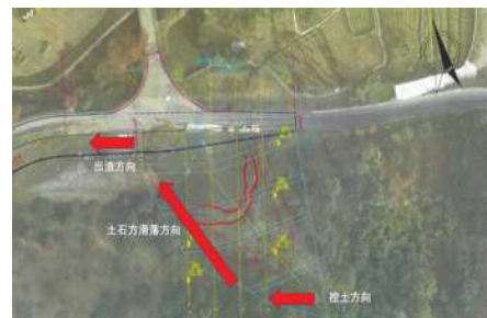
图8 土石方开挖出渣方向组织
