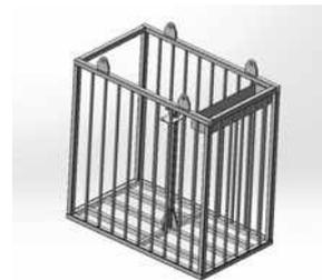
高强度铝合金防护缆车,为高空作业人员提供一个有效安全的作业位置。本身采用高强度6061铝合金材料,其屈服强度高达260mpa,其强度远超过施工中常用的Q235钢质材料。使用其整体重量仅为40公斤,仅为钢材的1/3重量。熟练的操作工,可以实现在高空进行组装的目的。实用性能大大增强。
