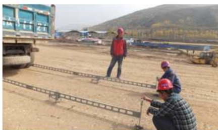
图2 施工控制和验收中回弹弯沉检测工作示意图
