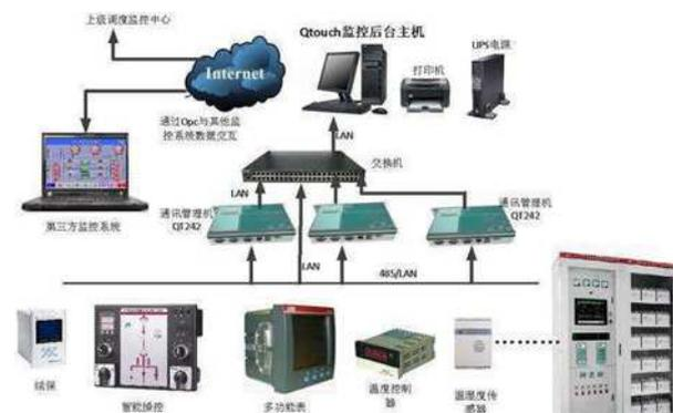
图1 电力监控系统的设备信息传输
