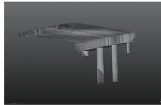
图 5.3-8 四十六号桥预处理后桥墩的点云图
