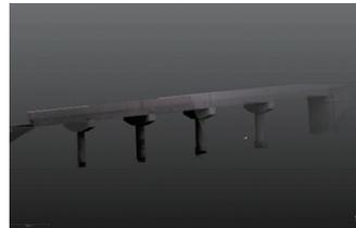
图 5.3-10 文村桥预处理后桥墩的点云图
