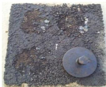
图 6 扭剪试验拉头
