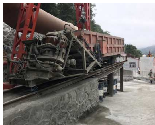
图1 轨行式喷浆车自动上料装置示意图
