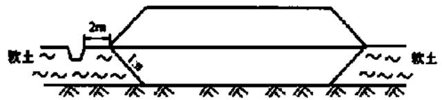
图2 软土地基换填示意图
