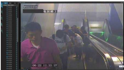
图11 上方人员遮挡导致电梯中下部的监控盲区图(2)
