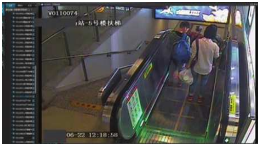
图10 上方人员遮挡导致电梯中下部的监控盲区图(1)
