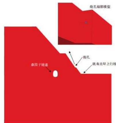
图2 既有有线扩堑工程桩板墙近接既有十里山一号隧道与北环下行线桑园子隧道
